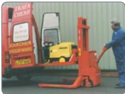
Die Plattform hier beim Transport eines Hochdruckreinigers.
