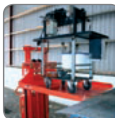
Logiflex mit Plattform hebt einen Werkstattwagen von der Rampe.
